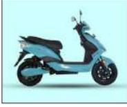
Okaya Faast F2F EV স্কুটারটি ৮০০W-BLDC-Hub মোটর দ্বারা চালিত। যার ৬০V ৩৬Ah (২.২ kWh) লিথিয়াম ION - LFP ব্যাটারি সর্বোচ্চ নিরাপত্তা প্রদান করে।
